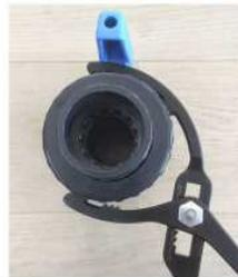
*La pince ci-contre a été spécialement conçue pour le serrage et desserrage des vannes et autres raccords à pas-de-vis.*
