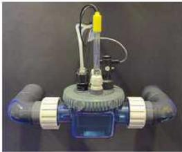
*Le Zéliapod est une petite chambre d'analyse conçue pour accueillir les sondes du régulateur pH - chlore et vous éviter ainsi la pose de plusieurs colliers de prise en charge et les risques liés à leur étanchéité.*
